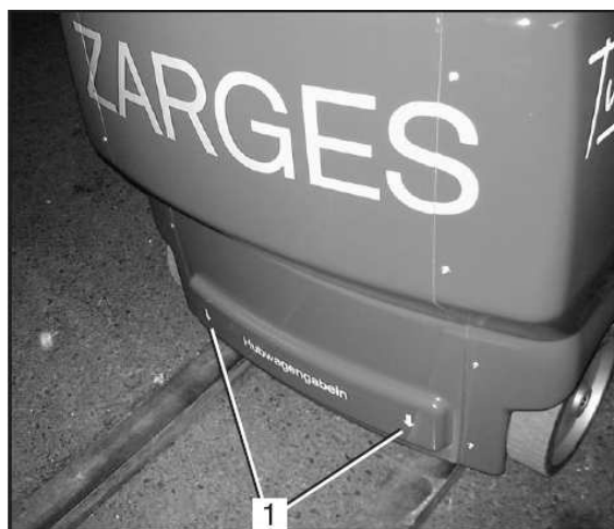
Obrázek 9 Body zachycení / uložení pro vysokozdvizný vozík
