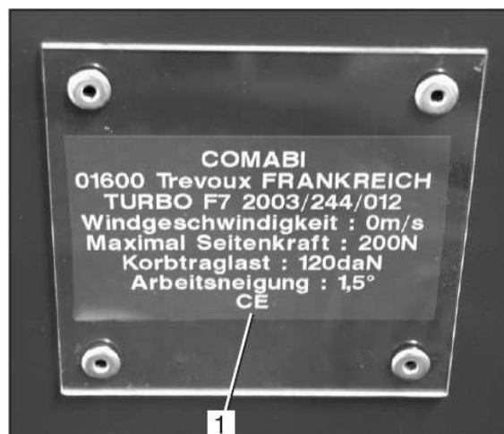
Obrázek 12 Typový štítek zvedací pracovní plošiny
