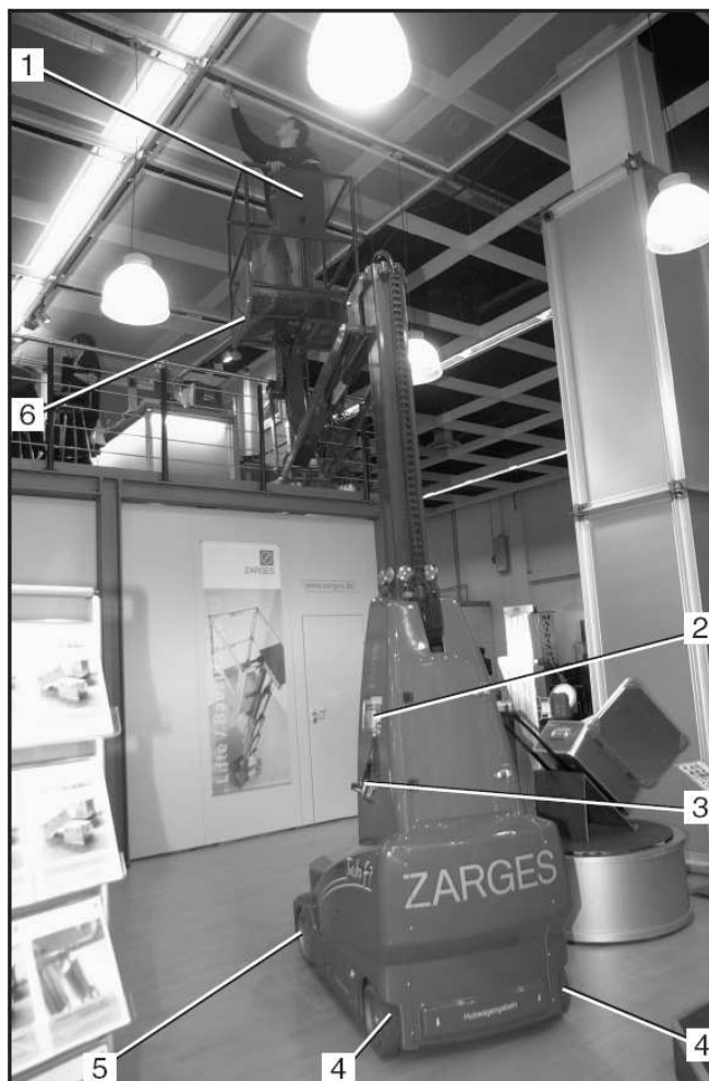
Obrázek 13 Základní vozidlo pojezdu s konstrukčními skupinami
