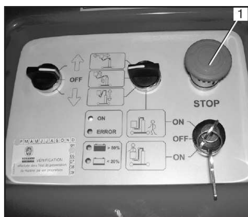
Obrázek 3 Nouzový vypínač na spodním místě obsluhy
