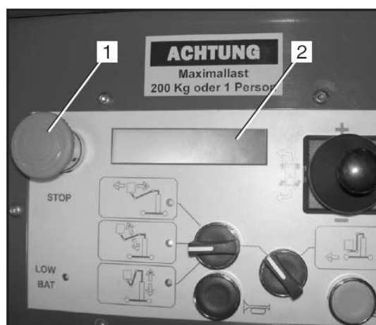
Obrázek 2 Nouzový vypínač na přístrojové desce
