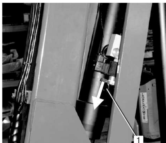
Obrázek 24 Nouzové spouštěcí zařízení kyvného stožáru
