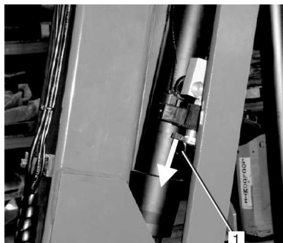
Obrázek 32 Nouzové spuštění kyvného stožáru
