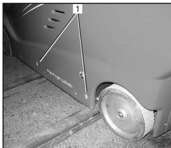
Obrázek 8 Body zachycení / uložení pro vysokozdvizný vozík
